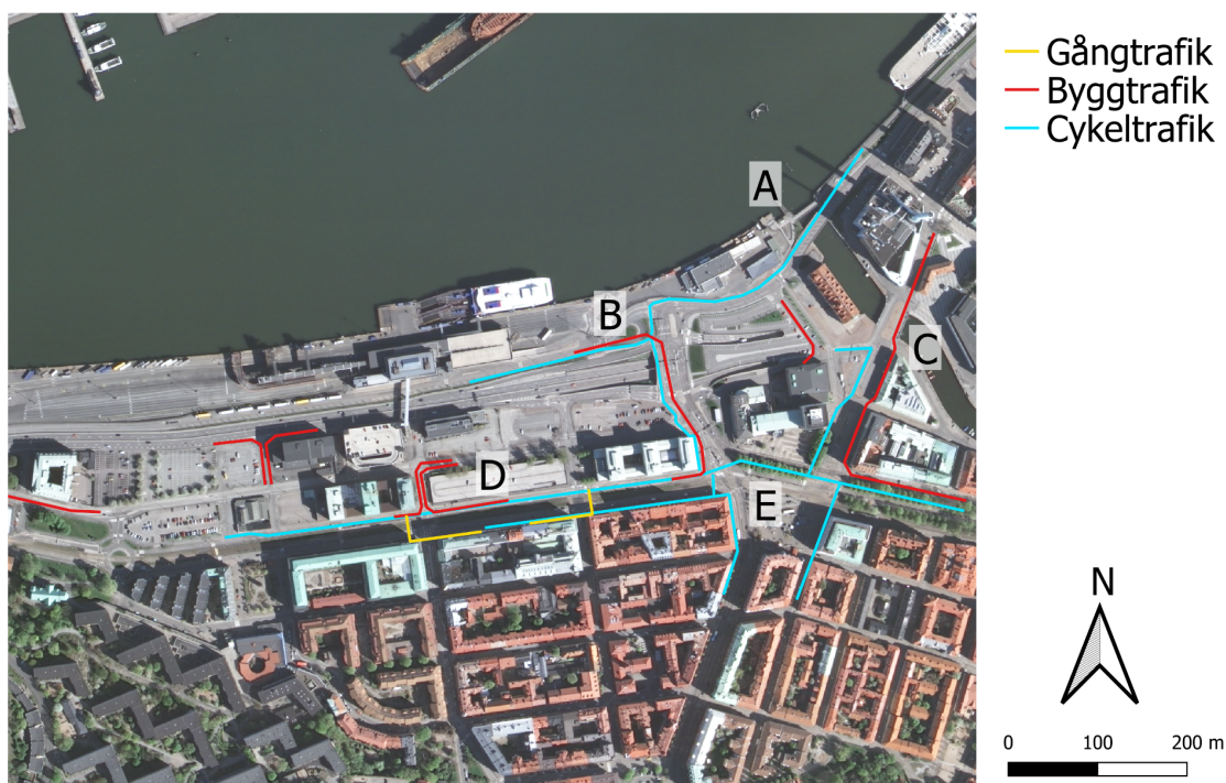
Figur 13. Karta över planerade vägar för gång-(gul), cykel-(blå), och byggtrafik(röd) för månaden februari 2022. (Egen bild, 2022).
