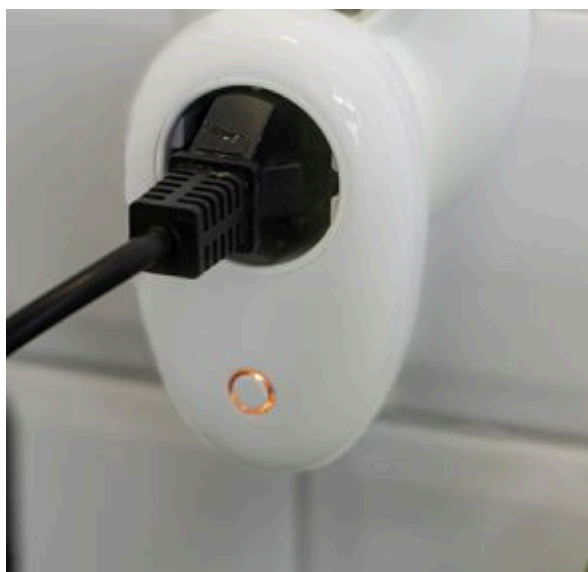
Figur 22: Smart Strömbrytare Skalhuset (u.å)
