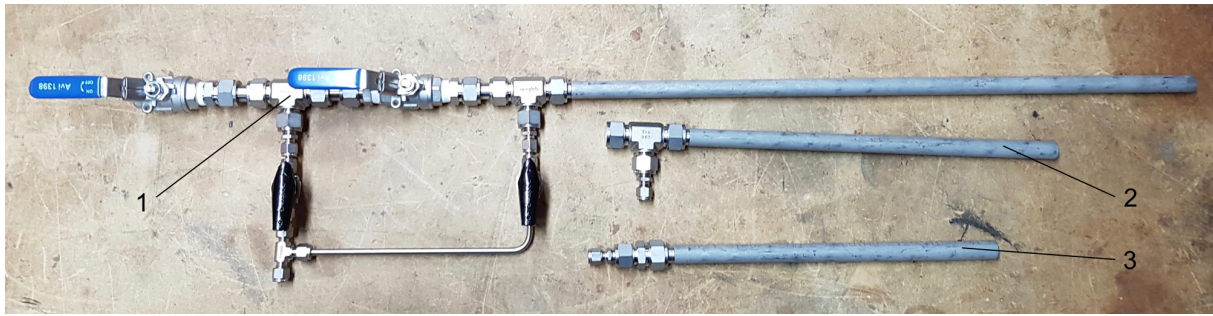
Figur 8: (1) Bränslematning med kvävesluss. (2) Gasuttag och port för termoelement. (3) Gasinflödesrör till botten av förgasaren.
