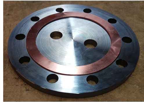
Figur 43: Kopparpackning i fläns.
