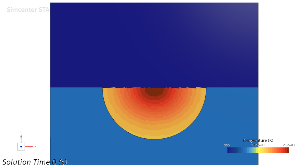
Figur 3: Initial temperaturfördelning för den halvcirkulära gropgeometrin. Temperaturfältet består av en bastemperatur i smältan kombinerad med en Gaussisk temperaturtopp nära smältans övre centrum.
