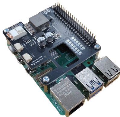
Figur 2.14: Bilden visar RPI med Powerhat monterad ovanpå. Notera raden med kontakter i bakkant som är GPIO anslutningar.
