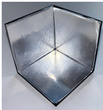
Figur 17: 3D-utskrivna hörnreflektor med aluminiumfolie
