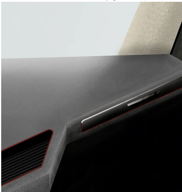
Figur 8.46 Utdragbart bord framför passagerarplatsen som kan användas som arbets- eller matbord.
