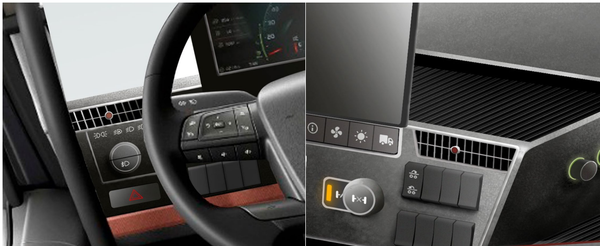
Figur 8.38 Reglage för utvärdig belysning, varningstriangel och fläktar.
