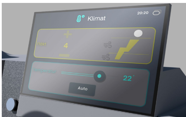
Figur 8.49 Konceptuell förslag för digitalt på gränssnitt för klimat.
