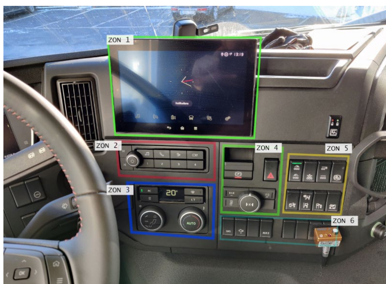
Figur 7.1 Visuell representation av de olika zonerna av kontrollpanelens högersida.
