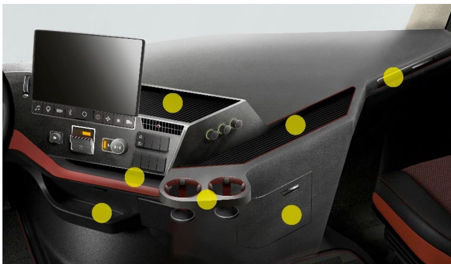
Figur 2.12. Illustration på avlastningsytorna vid förarsätet. Avlastnings- och förvaringsmöjligheterna är markerade med gula prickar.
