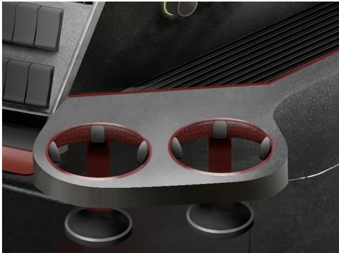
Figur 8.43 Mugghållarna är närmare föraren och har fler inställningsmöjligheter än i dagens FH.
