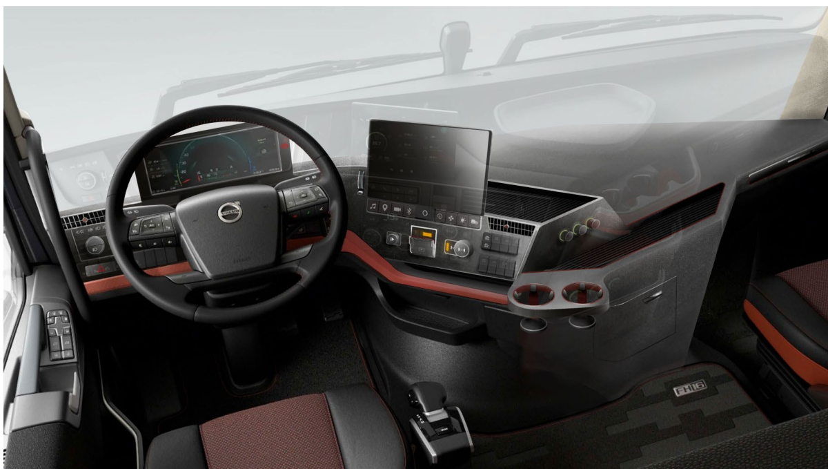
Figur 8.28. Bilden visar skillnaden i höjd mellan dagens instrumentbräda och det slutgiltiga konceptets instrumentbräda, där dagens instrumentbräda visas i låg opacitet.
