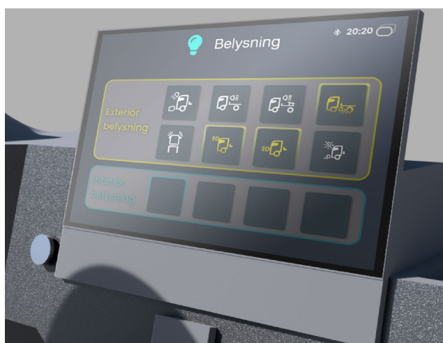
Figur 8.48 Konceptuell förslag för digitalt på gränssnitt för belysning.
