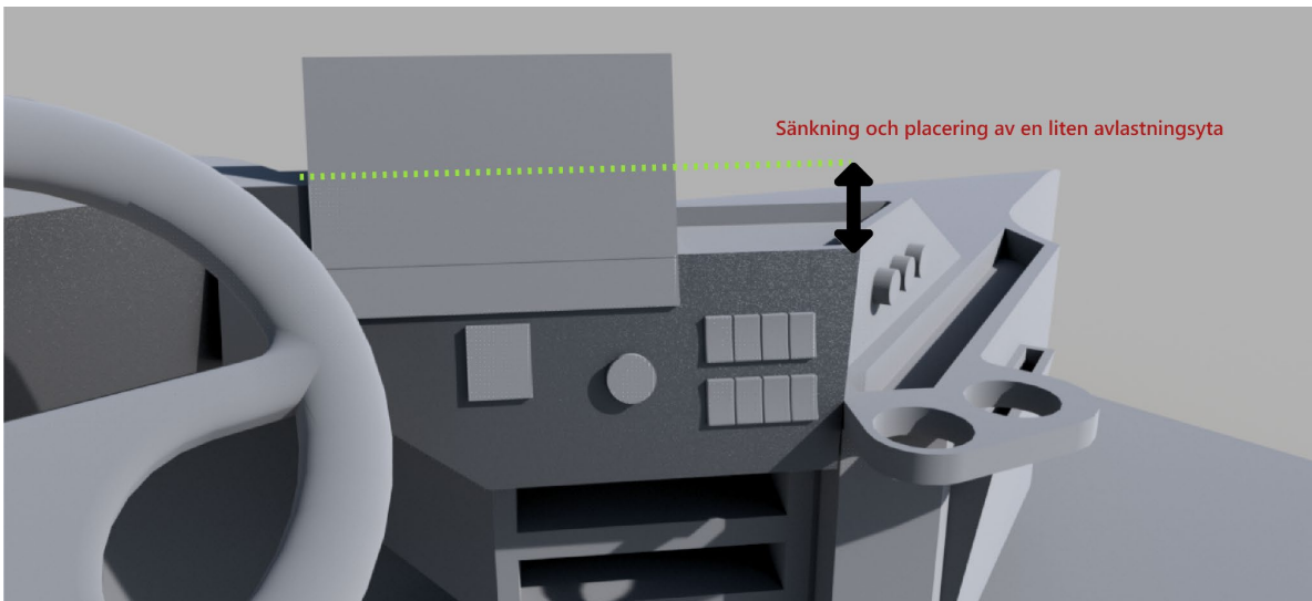
Figur 8.17 En illustrativ CAD-modell på utformningen av paneltopp och avlastningsytor.
