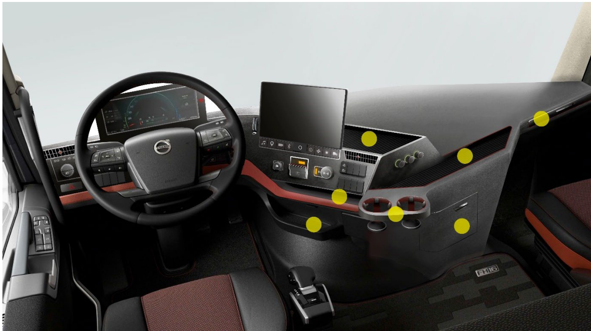
Figur 8.39 Helhetsbild av avlastningsytor & förvaring i slutgiltigt koncept. Avlastnings- och förvaringsmöjligheterna är markerade med gula prickar.
