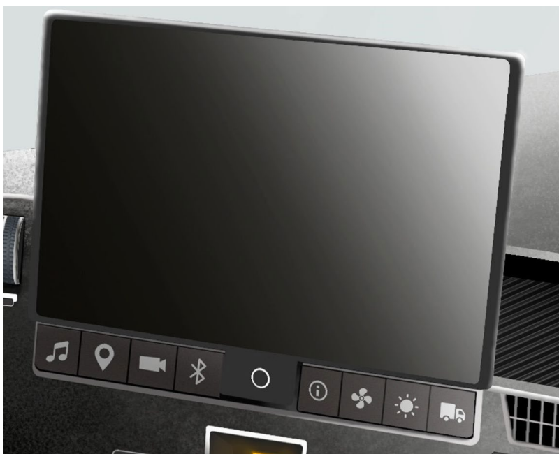
Figur 8.35 Touchskärmens utformning i slutgiltigt koncept.
