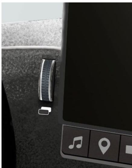
Figur 8.37 Reglaget för det digitala gränssnittets ljusstyrka återfinns till vänster om touchskärmen.
