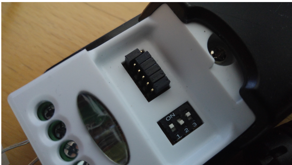
Figure 3.1: Inställningar för USB-till-RS485 adaptorn enligt [2]. Header Block överst och Operation mode S1, S2, S3 underst.
