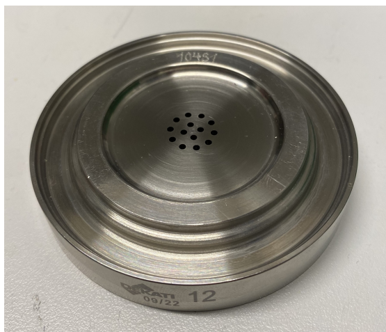
Figur A2: Munstycke 12 från kaskadimpaktorn i ELPI+.
