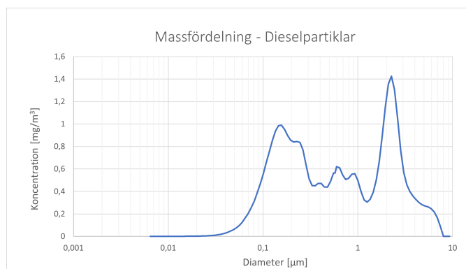
Figur 8: De insamlade dieselpartiklarnas massfördelning. Partiklarnas massa per volym i \text{mg/m}^3 är plottad mot dess partikeldiameter i \mu\text{m} . Skalan för partikeldiameter är logaritmisk.
