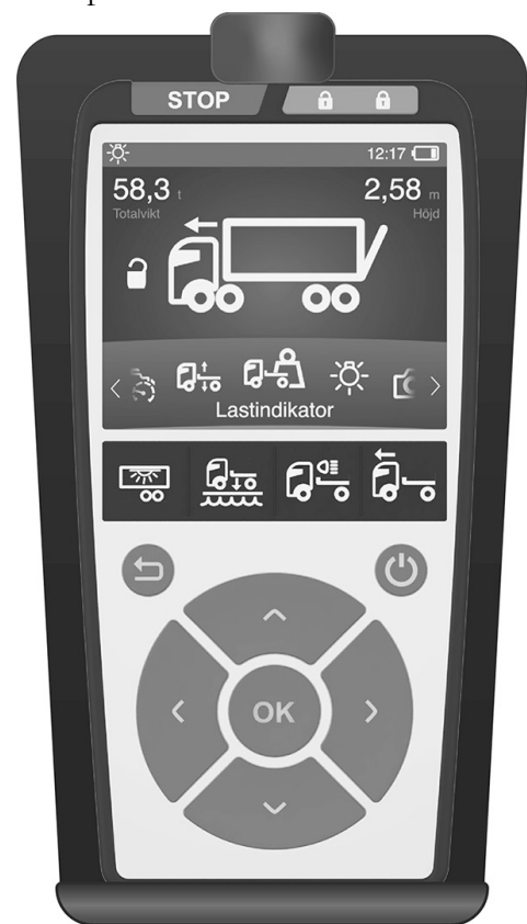
Figur 15: Slutkonceptet placerat i ett konceptförslag på en hållare med integrerad laddare
