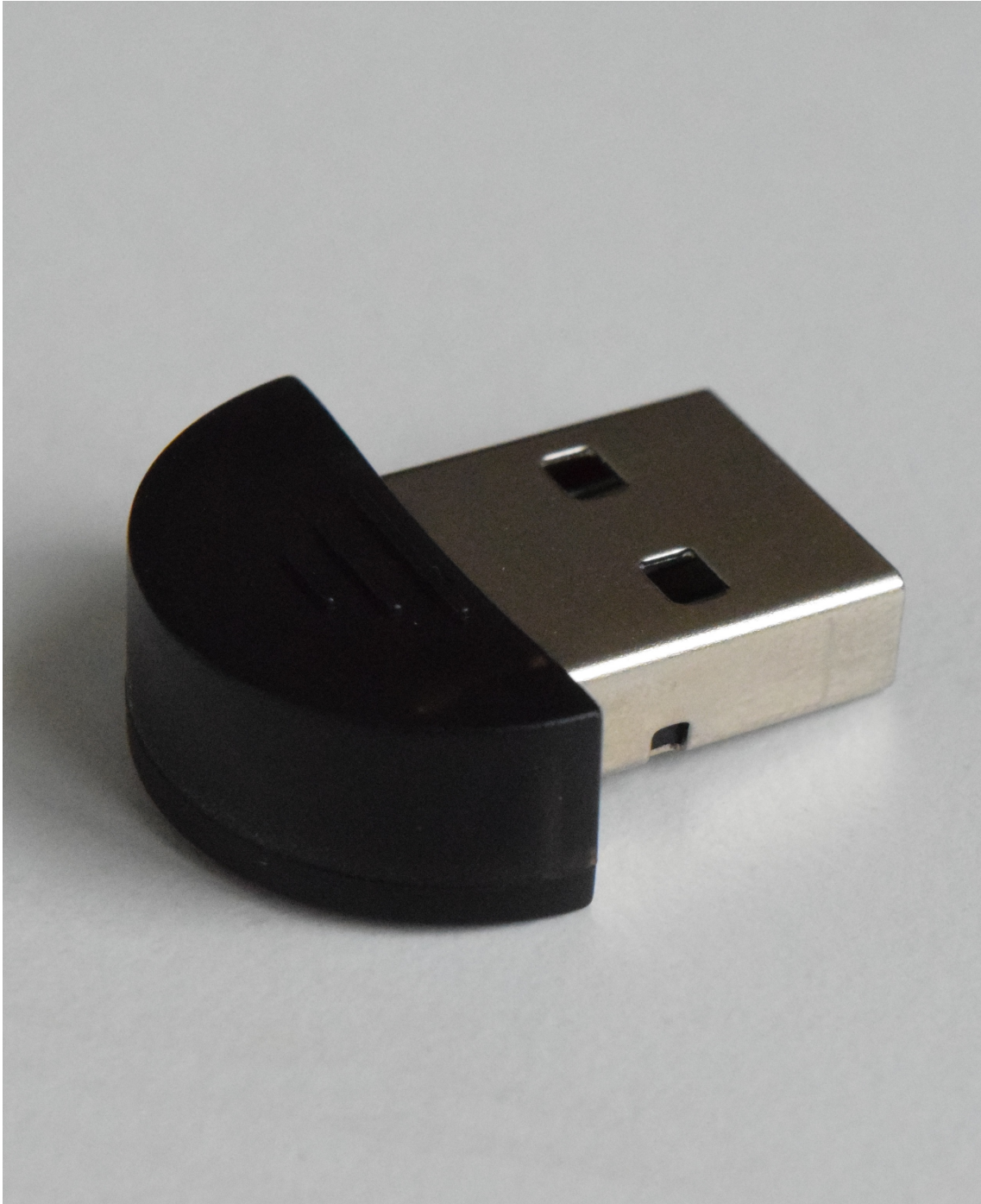
Figur 20: Bild på USB-dongeln för Bluetooth-kommunikation som följer med Balanduino-roboten.
