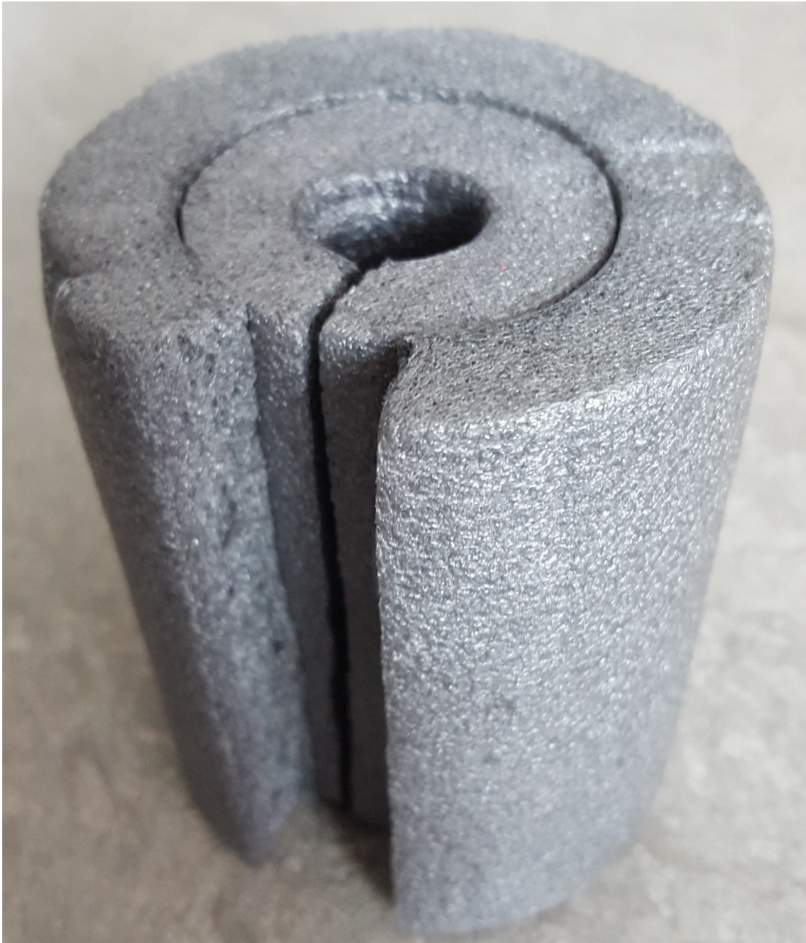
Figur 19: Skydd för Balanduino gjort av två lager rörisolering.
