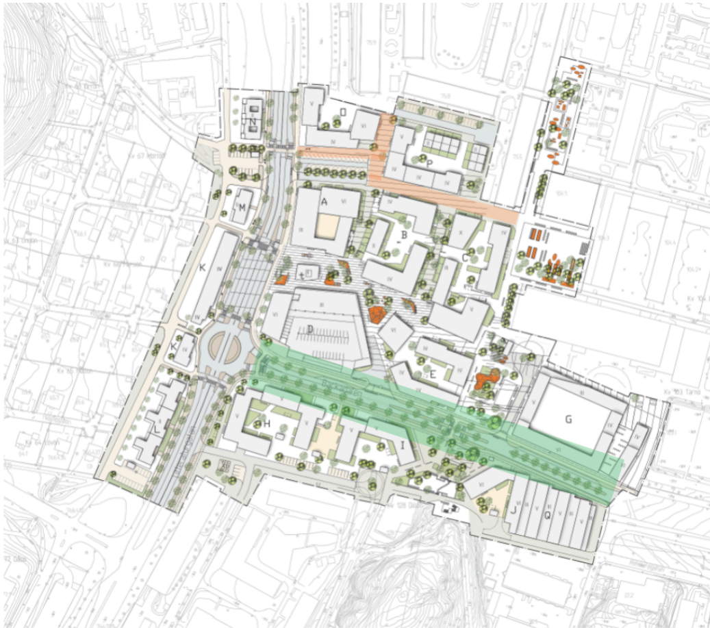
Figur 20. Detaljplan för Selma Lagerlöfs torg som lågfartsgata, orange, och cykelbanor och trottoarer med kantsten, grön (Göteborg Stad, 2014).
