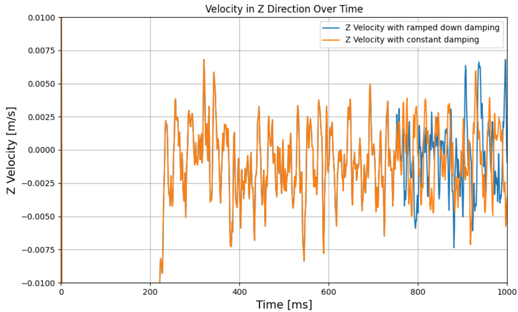
Figur 4.15: Hastighet för ASIS med kritisk dämpning (perioden T=600 ms) för VIVA+ 50F. Orange kurva avser konstant dämpning. Blå kurva avser konstant dämpning fram till 750 ms, med en linjär minskning av dämpningen mellan 750 ms och 800 ms till 0. Hastighet i z-led visas som funktion av tid.
