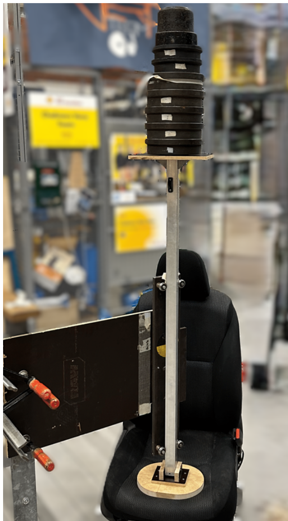
Figur A.1: Det fysiska testet av bilsätet i valideringsprocessen av den virtuella sättesmodellen. Här används den elliptiska formen på främre delen av sätet.
