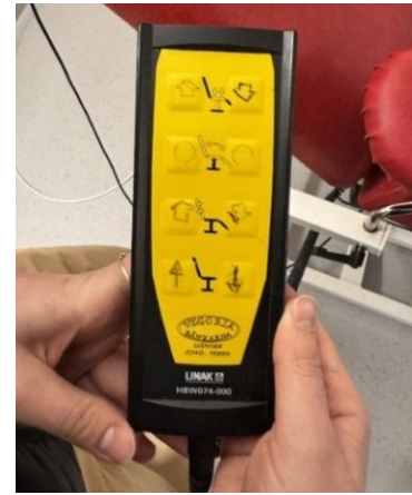
Figur 11: Reglage för justering, kompletterat med egen märkning
