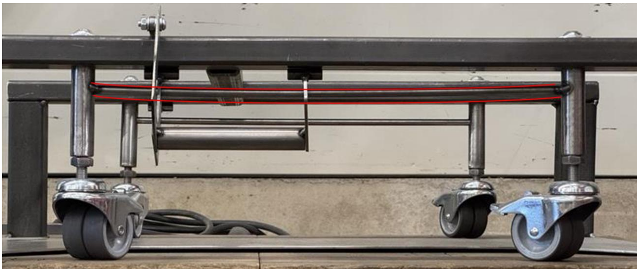
Figur 43: Tvärgående stång som böjs vid belastning, illustrerat med röda linjer.
