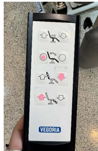
17: Rosa märkning på reglaget förtydligar hur man aktiverar chockläge
