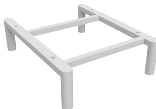
Figur 38: Bärande konstruktionen på underredet
