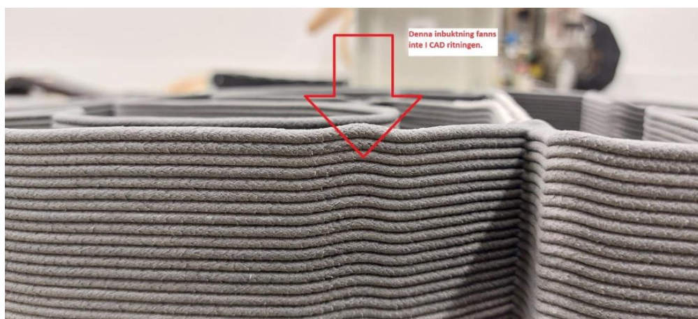
Figur 11. Defekt i utskrift av RISE logga.
