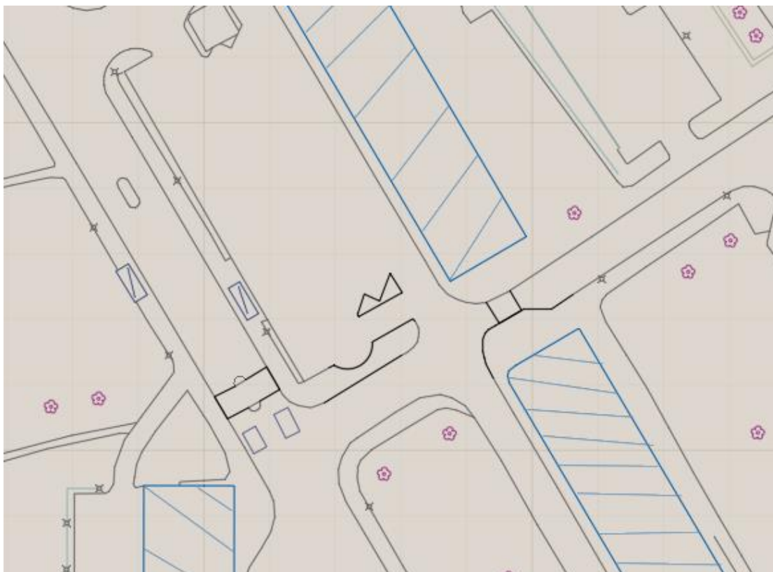
Figur 4.18. Förslag 1 med en avsmalning med upphöjt övergångsställe i början på Olof Rudbecksgatan. Även mindre förändringar på parkeringens utförande.
