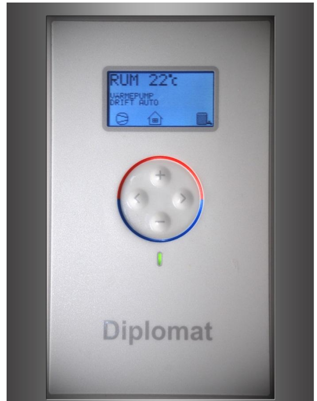
Figur 4.1 – Nuvarande gränssnitt med knappar, display och larmindikator.
