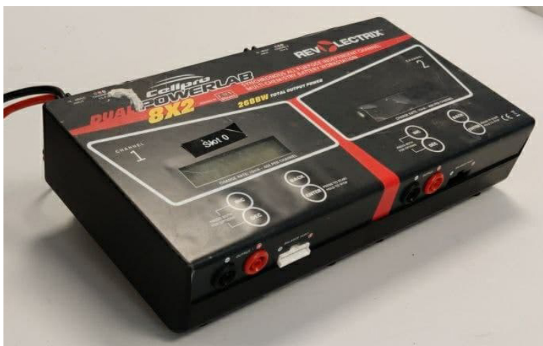
Figur 6.1: Laddare av modell Cellpro Dual PowerLab 8x2
