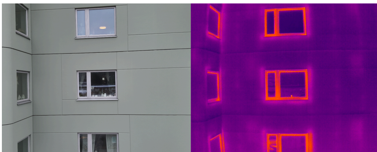
Bild 7: Visar RGB-bild och värmebild sida vid sida från fasadinspektion. Plan 6. Ingen indikation på fel men rapporterade inläckage likt läckagen beskrivet i bildtexterna för både bild 5 och 6.
