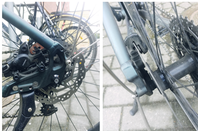
Figur 3: Bild på fastmonterad skivbroms på cykel. Figuren till vänster visar en fastmonterad skivbroms i bak på en cykel. Figuren till höger visar bromskivan mellan bromsbeläggen som i sin tur sitter i bromsoket.
