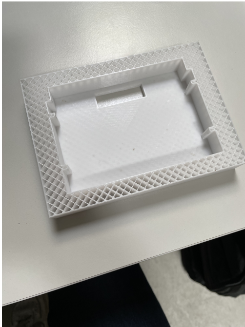
(a) 3D skrivning för passform av batteriet
