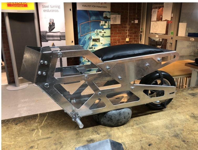
Figur 25: Prototyp utan styre, men med fotstöd och säte samt bakhjul
