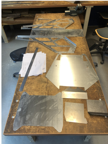
Figur 22: De första vattenskurna delarna upplagda
