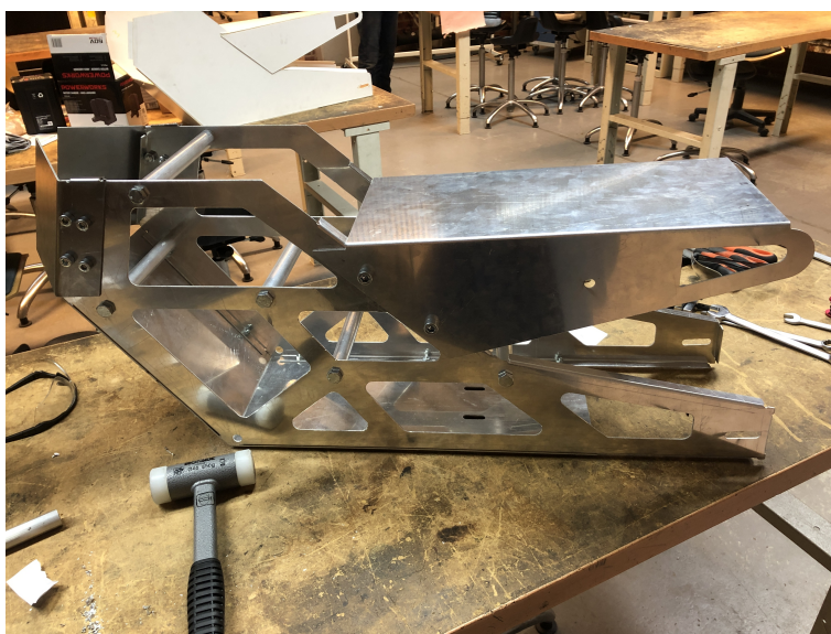
Figur 24: Efter ramsidorna satts ihop med stöttepinnar, säte och underdel
