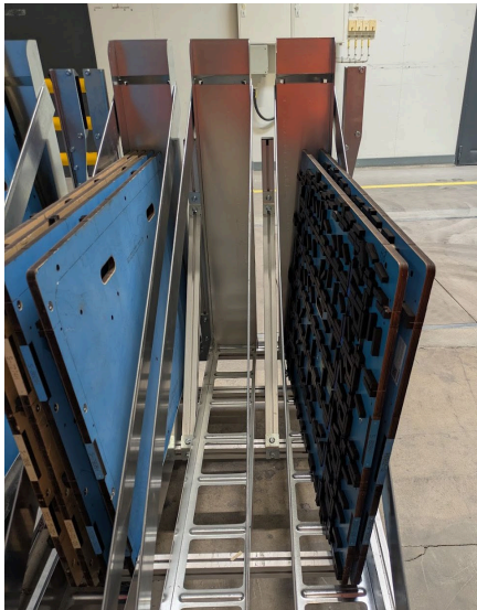
Figur 19. Stansmallar med matriser. (Författarens egen bild).
