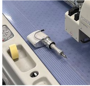
Figur 13. Skärkniv. (Författarens egen bild).
