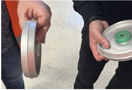
Figur 12. Hjul för bigning. (Författarens egen bild).
