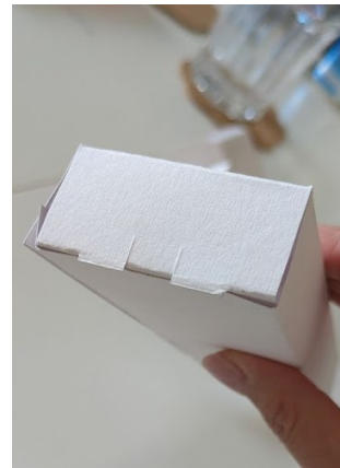
Figur 64. Test av låsmekanism. (Författarens egen bild).
