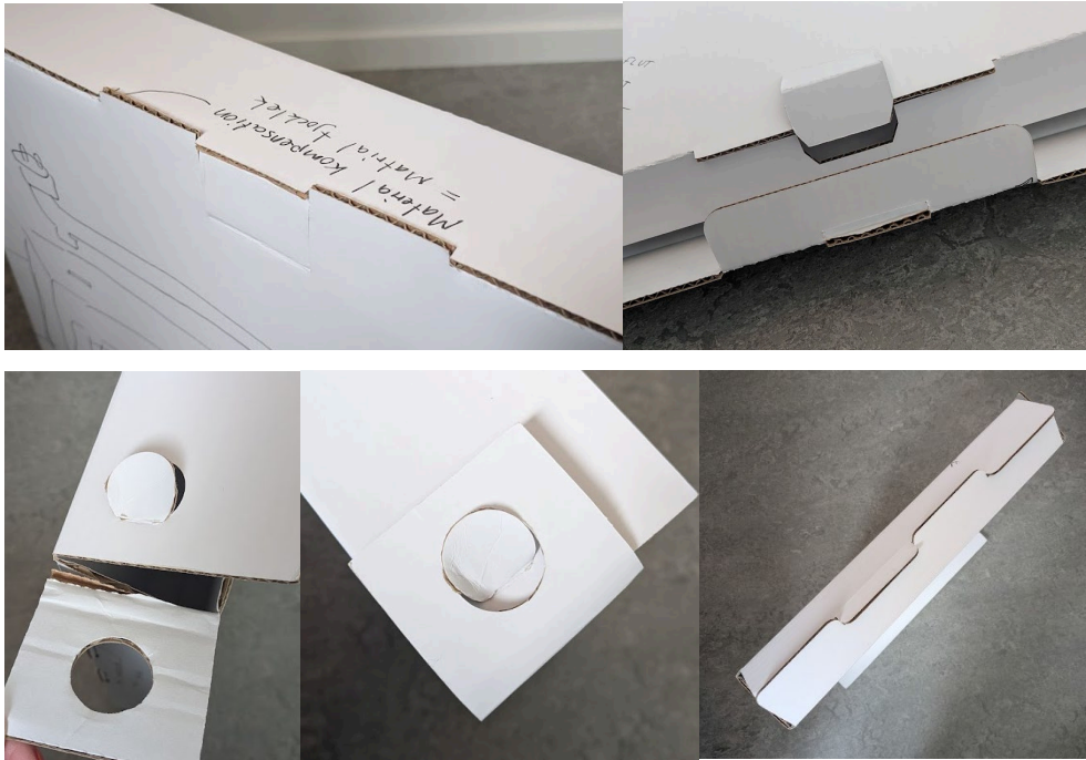
Figur 7. Olika typer av låsflikar.
