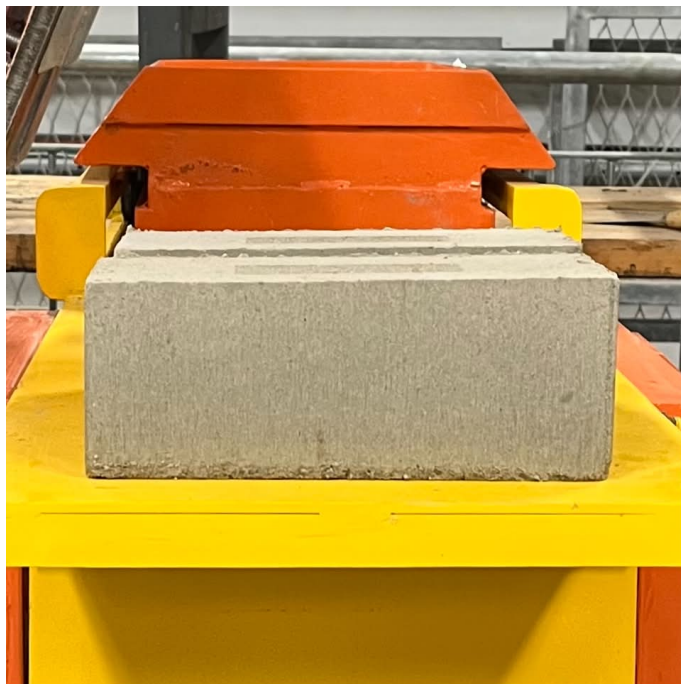
Figur 5.6: Exempel på blockens lutning, se ovansida, på grund av pressplåtarnas något felaktiga inställning.
