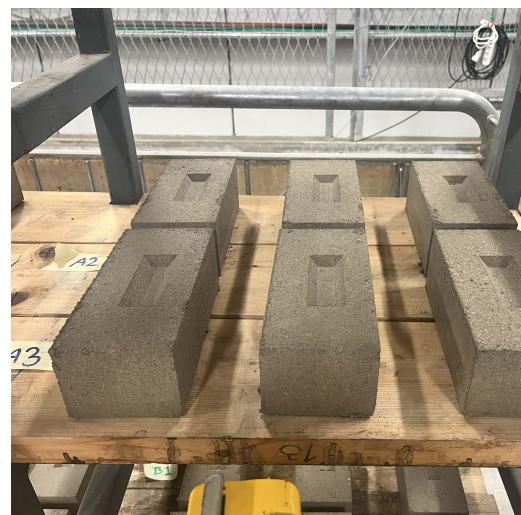
(d) Torkning av pressade jordblock i trähylla.
