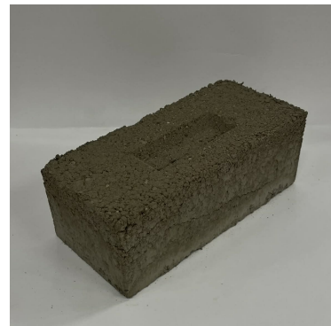
(c) Testblock 3 - 55% sand, 45% lera, 8% vattenhalt av jordblandningen.
