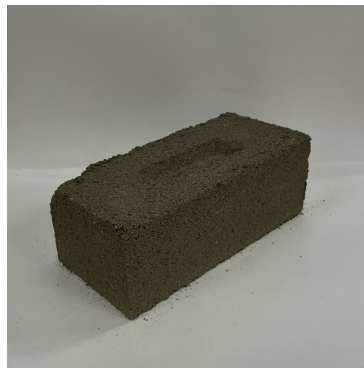
(b) Testblock 2 - 60% sand, 40% lera, 8% vattenhalt av jordblandningen.
