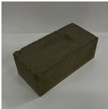
(a) Testblock 1 - 60% sand, 40% lera, 9% vattenhalt av jordblandningen.
