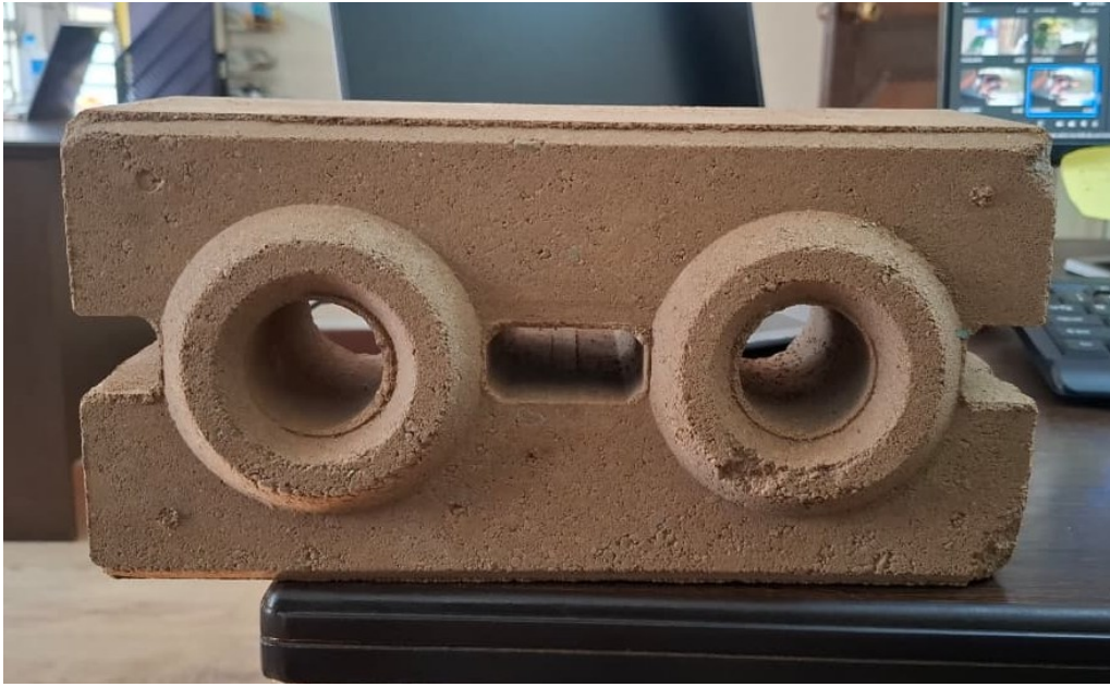
Figur 1.1: Exempel på utformningen av ett ICSEB i användning inom Build up Nepal med genomgående hål för armering. Bild erhållen från A. Shrestha, representant för Build up Nepal (personlig kommunikation, apr, 2026).
