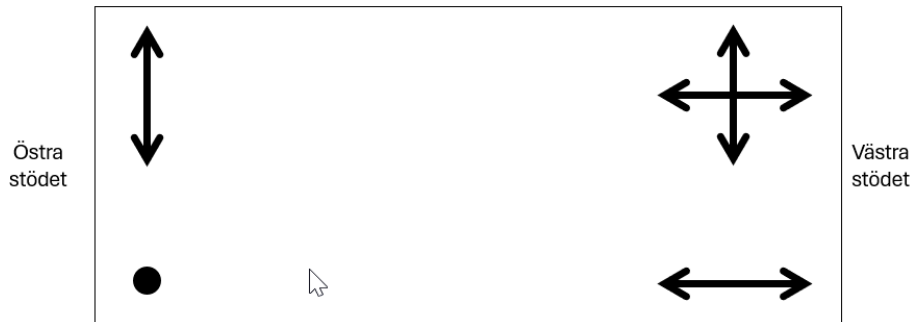
Figur 7.4: Skiss av frihetsgrader för alla lager
