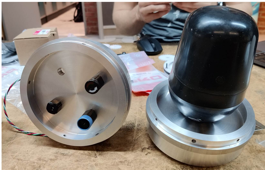
Figur 5.4: Blåsan monterad på lock
