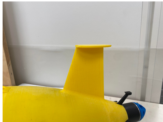
Figur 4.26: 3D-skriven fena fäst på bakre kåpan
