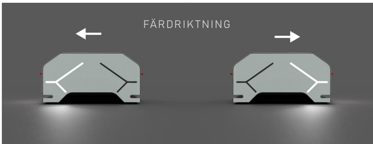
Figur 8.7. Ljusindikation i färdriktning.
