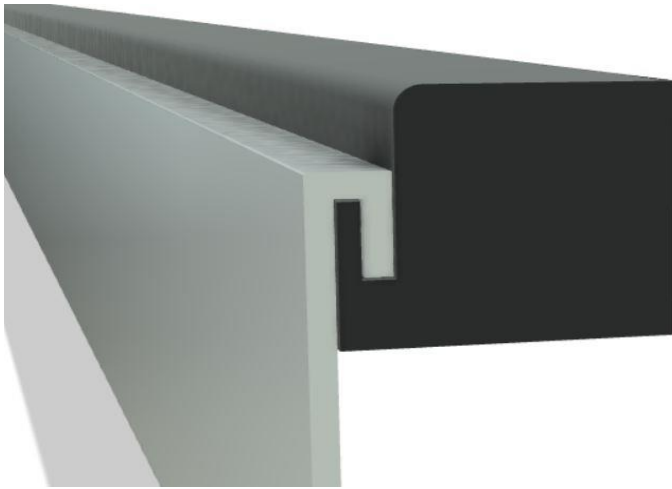
Figur 7.2. Visualiserat förslag på fäste mellan lucka (grå) och ram (svart).
