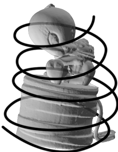
Figur 4.4.a. Sensorinläsning i en spiral runt objektet
