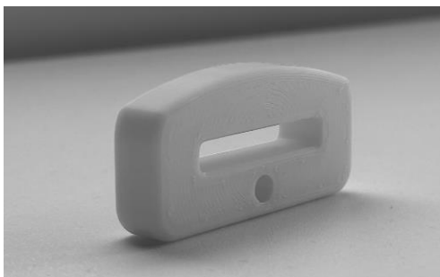
Figur 42: 3D printad prototyp av komponent metalldel
