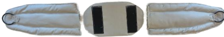
Figur 19: Prototyp med integrerade sömmar och varierande vadderingsstjocklek för att möjliggöra kontrollerad böjning av bältets kanter.
