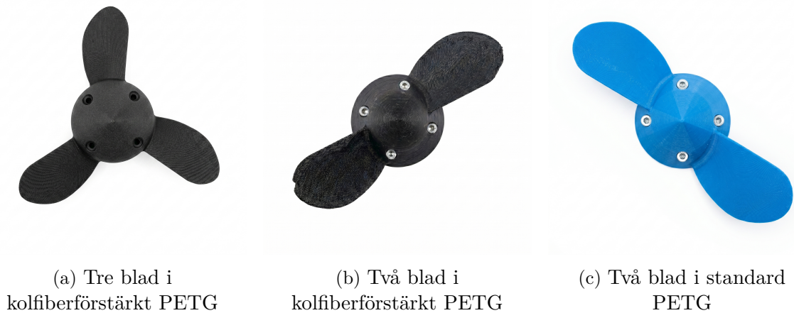
Figur 4.2: Propellrar som utvärderas under prestandatestet
