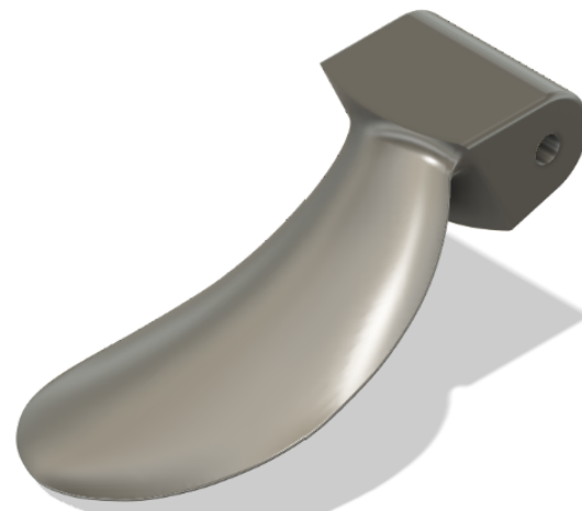
(d) Ett av två propellerblad baserat på motorns medföljande propeller
