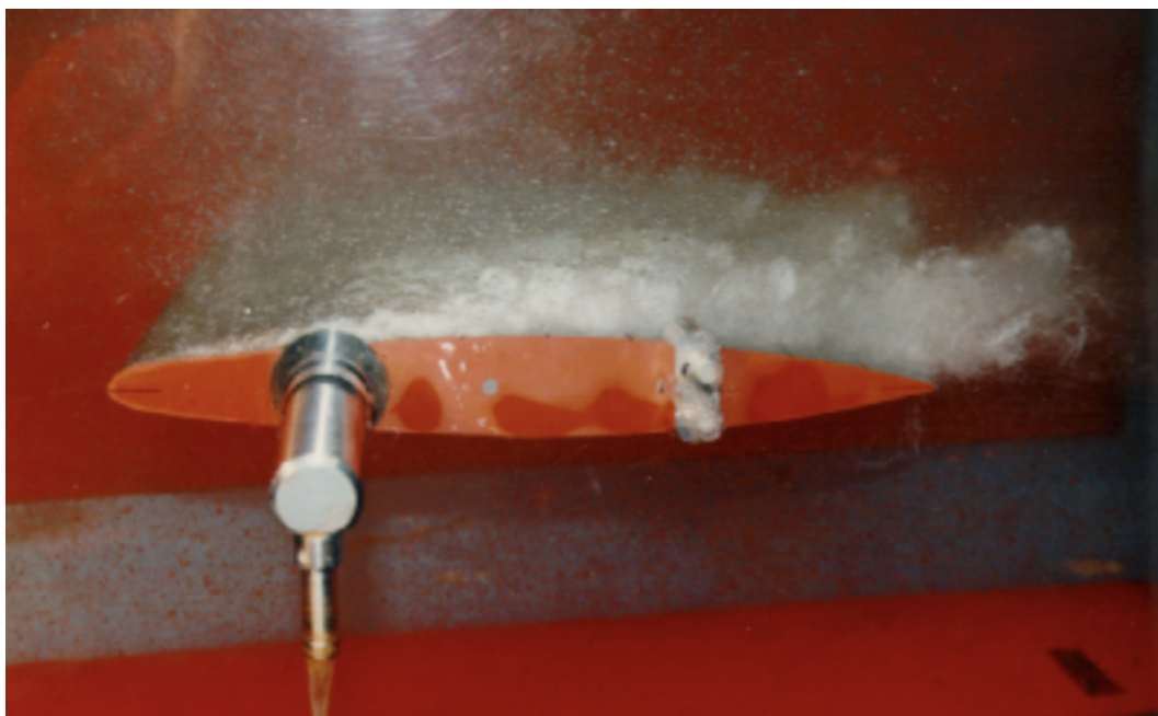
Figur 2.22: Kavitation runt ett bärplan (S.A.Kinnas, 1996)
