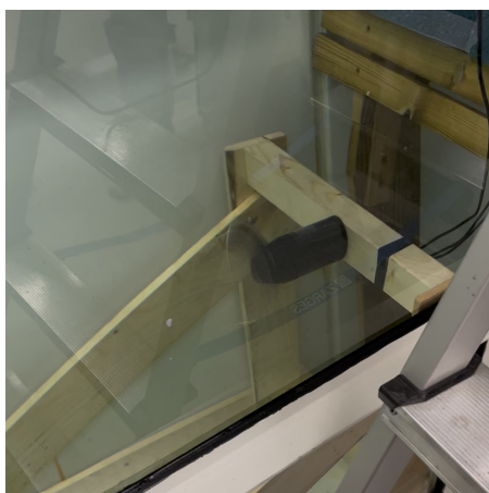
(a) Motor nedsänkt i vatten och monterad i rigg
