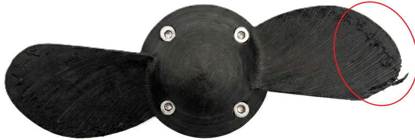
Figur 5.4: Deformation 2-bladig kolfiberförstärkt propeller
