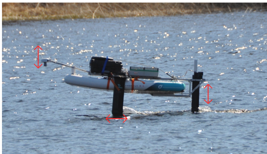
Figur 5.8: Båten i flygande läge med vibrationer
