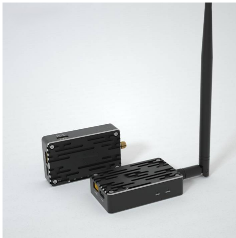
Figur 3.36: Trådlös sändare och mottagare för realtids-telemetri
