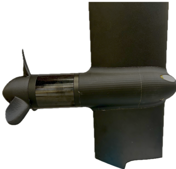
Figur 3.9: Motorfäste, motor och propeller monterad runt mast
