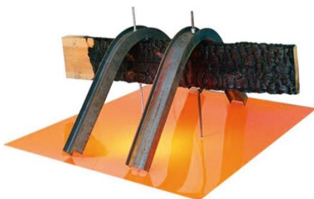
Figur 5. Stål i jämförelse med trä vid brand. Från [9]. Återgiven med tillstånd.
