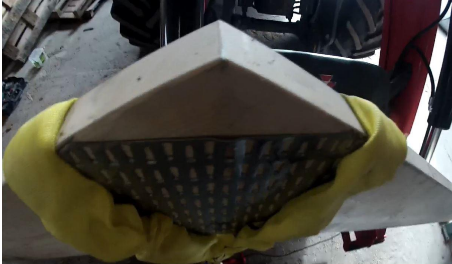
Figur 40. Spikplåten buktar utåt i överkant vid skarven.
