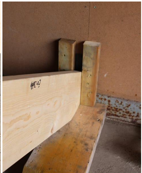
Figur 17. Fast inspänt upplag mot vägg.
