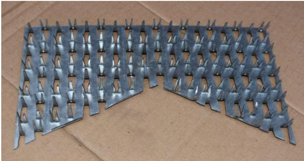
Figur 9. Undersida av avkapad spikplåt.
