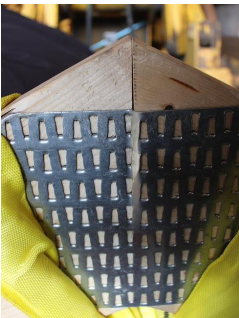
Figur 24. Spikplåten bockas och spel = 0 mm, innan brott.
