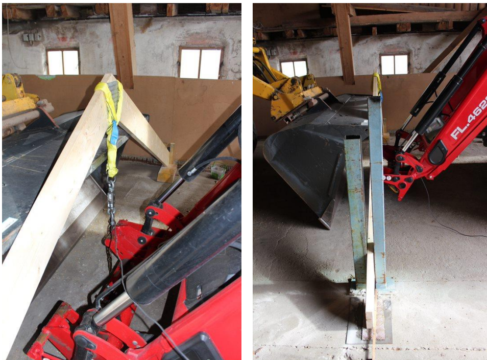
Figur 14 och 15. Takstol i teststation.
