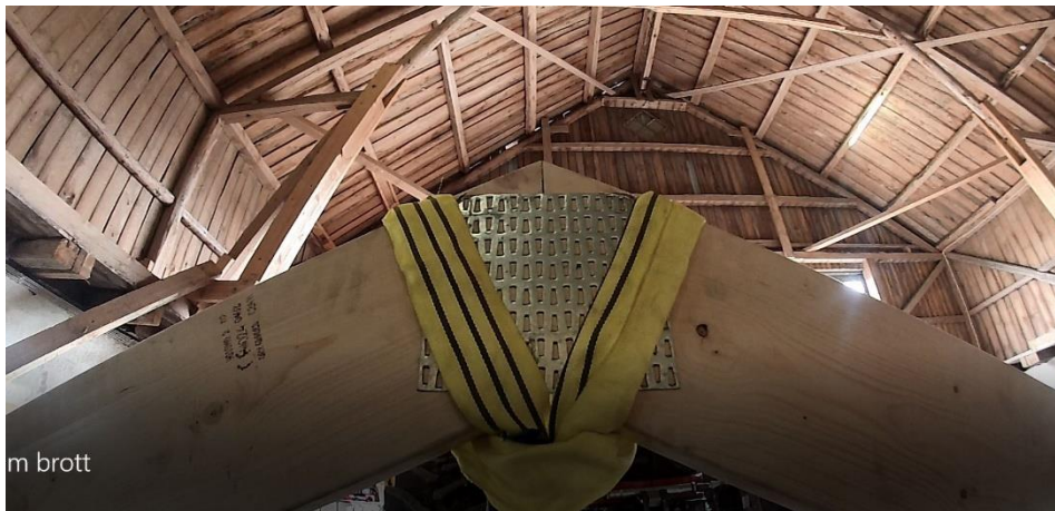
Figur 38. Kvalitet 2 mm. Nock oförändrad.
