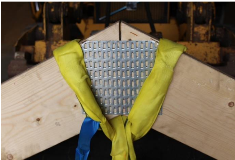
Figur 23. Takstol 5 mm innan belastning.
