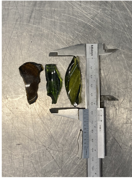
Figur 5.1: Krossat glas från fraktion 8/16 som visar kornens flisiga och stängliga geometri samt att längden överskrider maximal kornstorlek för gällande fraktion
