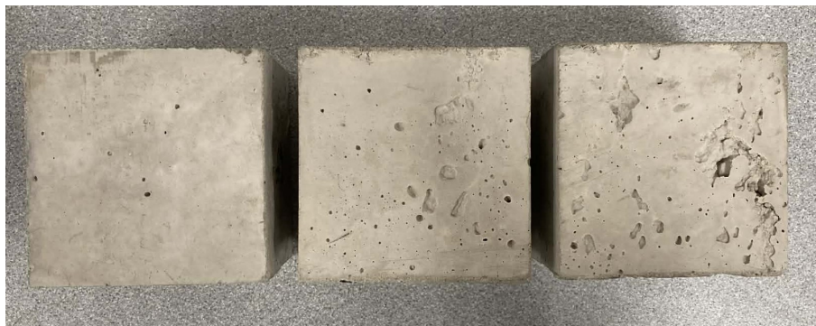
Figur 4.1: Ytstruktur hos hårdnade provkroppar. Från vänster: representativ yta för majoriteten av provkropparna, avvikande provkropp från G3 och avvikande provkropp från G2
