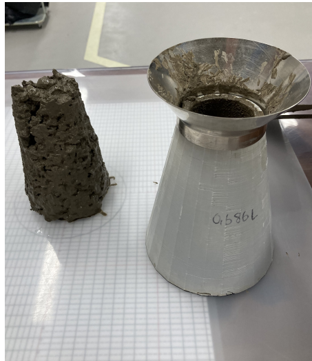
Figur 3.4: Utrustning för konsistensprovning med sättmått och ett representativt betongprov
