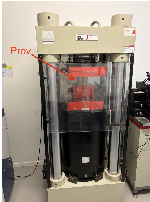
Figur 3.5: Tryckpress från Toni Technik använd vid tryckhållfasthetsprovning
