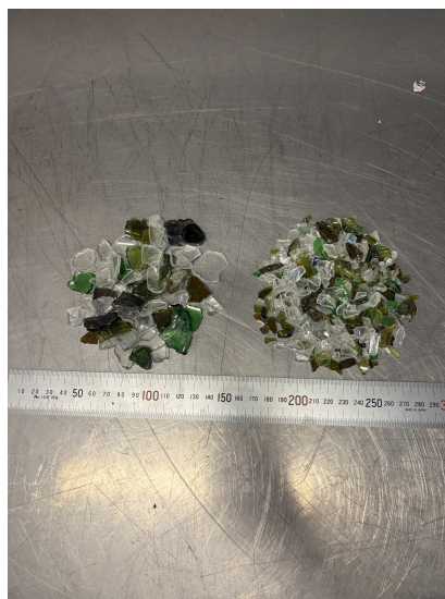
Figur 3.2: Fraktion 8/16 mm till vänster och 4/8 mm till höger
