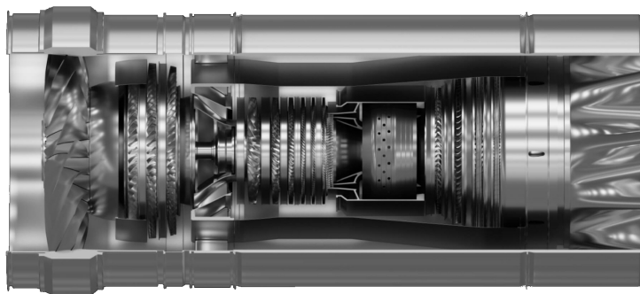
Figur 2.5: En rendering av turbofläktmotorn Boom Symphony. (Boom Technology, u.åb) Återgiven med tillstånd.
