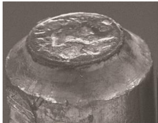
Figur 2.4.1 Kraftigt försliten toppyta hos en elektrod. [2]
