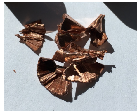
Figur 2.6.7. Spånor efter formering.
