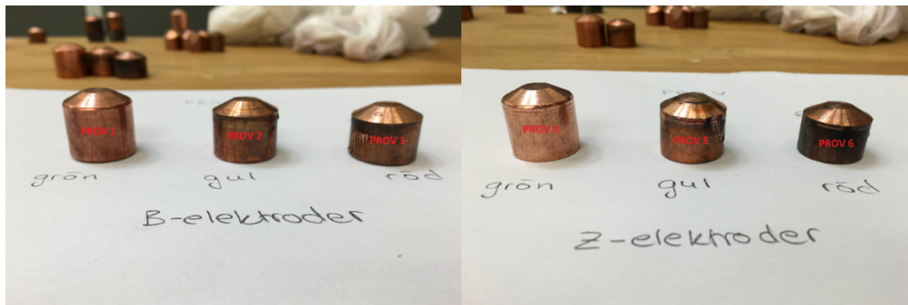
Figur 3.4.1. Bild tagen av prov 1-6 från vänster till höger innan hårdhetsmätningen. De tre första elektroderna är B-elektroder och de tre sista är Z-elektroder.
