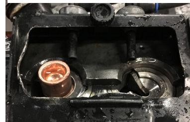
Figur 2.6.6. Elektrod som fastnat i formerare.
