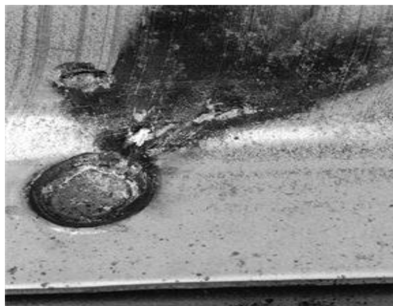
Figur 2.5.2. Utbränd yta på grund av svetssprut. Med tillstånd från G.E. Schmidt, Inc. [14]
