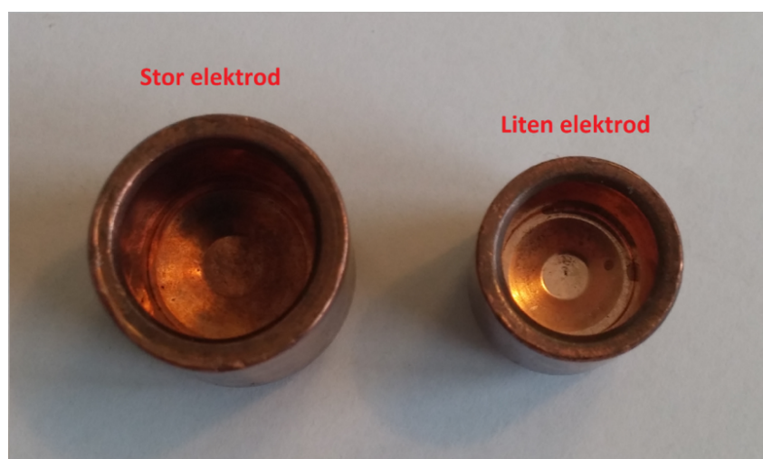
Figur 2.3.2. Elektrodenas utseende underifrån.
