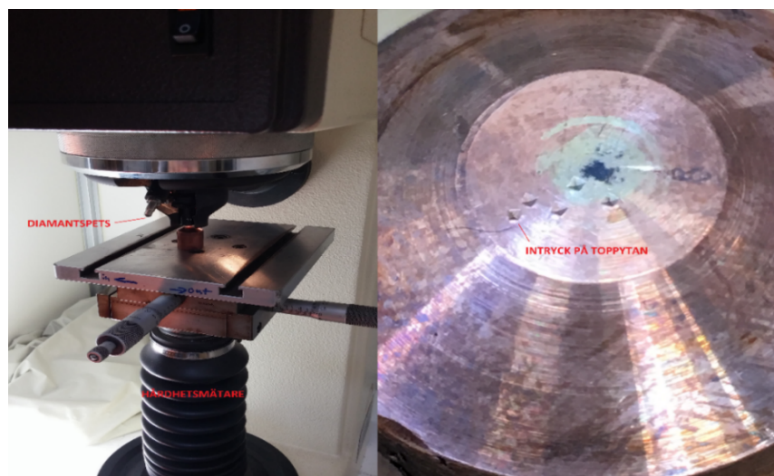
Figur 3.4.2. Hårdhetsmätare samt intryck på toppytan hos ett av proverna.
