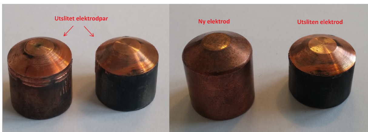
Figur 2.4. Till vänster: utslitet elektroddpar. Till höger: ny elektrod samt utsliten elektrod.
