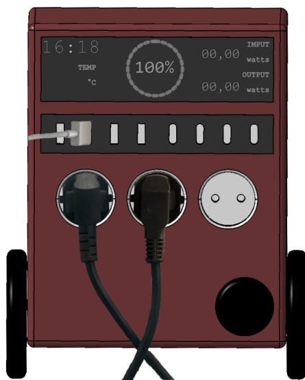
Bild 16: CAD-modell "resväska" visar uttag och display
