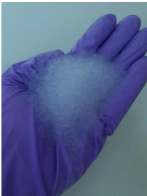
Figure 2.2. Silica aerogel granules (Karim et al., 2020a).
