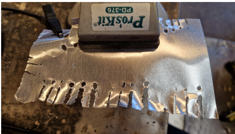
Figur A.2: Skärtest för hand på 60-70 \mu\text{m} tjock aluminiumplåt, bild 2.
