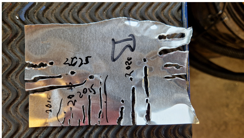
Figur A.4: Skärtest för hand på 95-115 \mu\text{m} tjock aluminiumplåt, bild 4.
