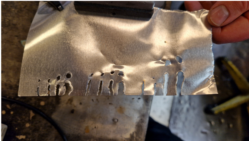
Figur A.1: Skärtest för hand på 60-70 \mu\text{m} tjock aluminiumplåt, bild 1.
