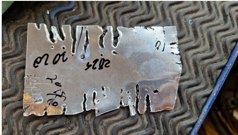
Figur A.6: Skärtest för hand på 230-250 \mu\text{m} tjock aluminiumplåt, bild 6.
