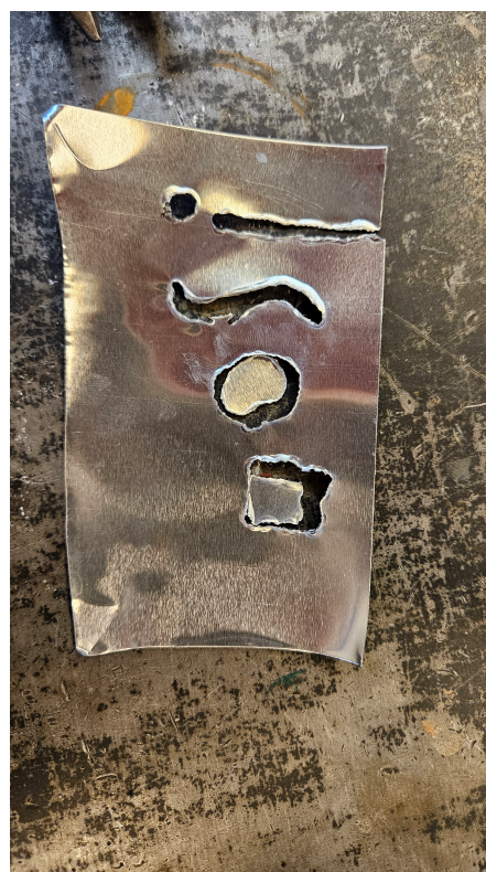
Figur 3.2: Försök att skära figurer/mönster med handhållen skärning med grafit elektrod.
