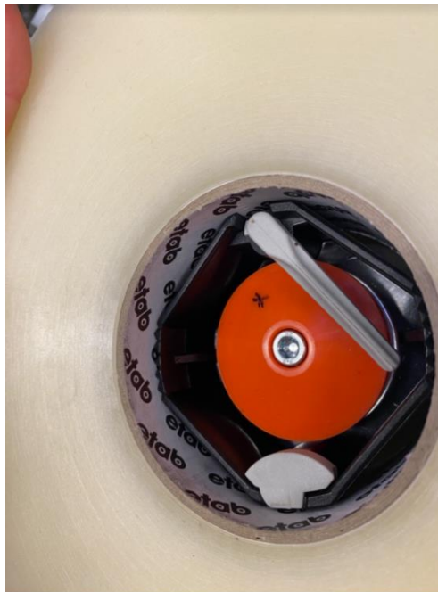
Figur 3: Tejprollen med skruv i centrum för att ställa in bromsstyrkan.
