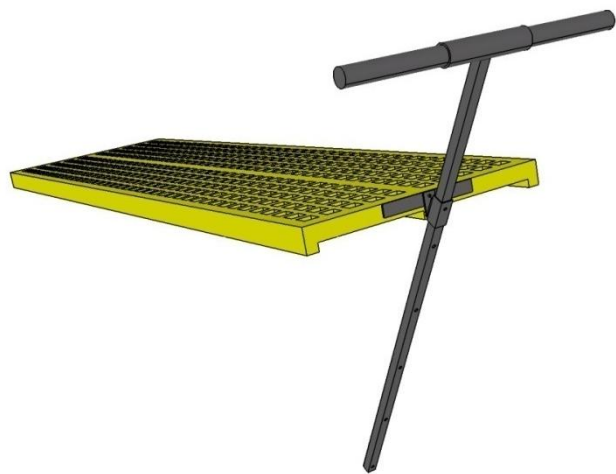
Figur 20. Mekanism för att ställa in siktstållets vinkel.
