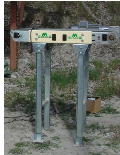
Figur 9. Transportbandet som användes till att mata sikten med material.
