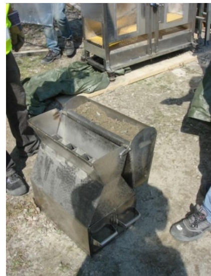
Figur 10. Neddelare som används för att dela ned stenproverna till hanterbar storlek.
