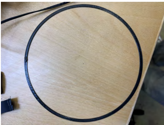
(c) Nya distanser och tätningssringar i test 2.
