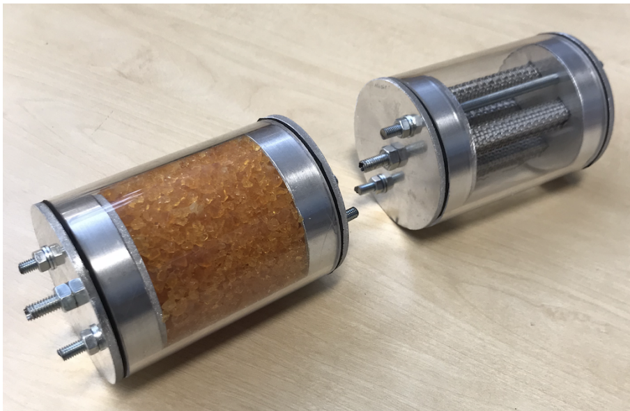
Figur 4.1: Diffusionstork med och utan silica-pellets. Notera filterpapperets positionering inuti genomlöpsröret i enheten till höger i figuren.
