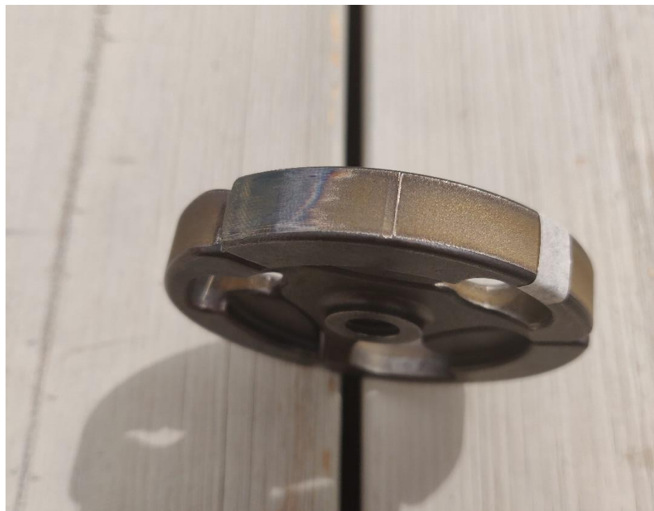
Figur 29. Koncept 1 efter provkörning, slitytan syns till vänster, optimalt hade varit att kontakt med trumman erhållits ungefär till den vita markeringen.
