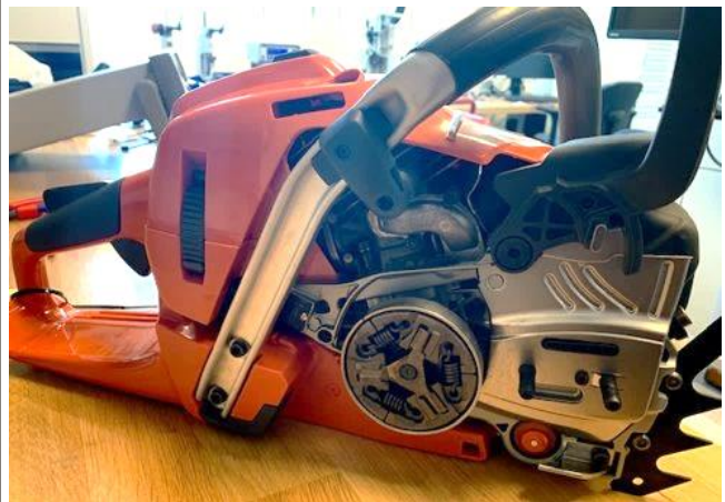
Figur 4. Dagens koppling i motorsågen
