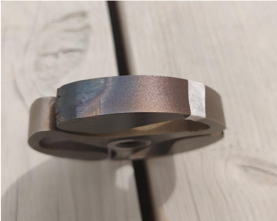
Figur 30. Koncept 4 efter provkörning, slitytan syns till vänster, optimalt hade varit att kontakt med trumman erhållits ungefär till den vita markeringen.
