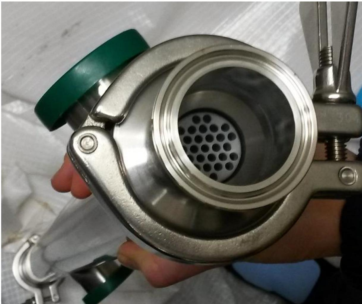
*Figur 2: Membranets tvärsnittsyta skymmas i öppningen för koncentratet.*
