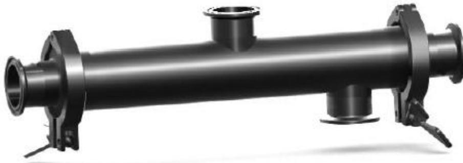
*Figur 1: Membranhus med öppning för inflöde (längst till vänster), koncentrat (längst till höger) och permeat (till höger riktat nedåt). På mitten av membranhuset finns en anslutning till BPH.*
