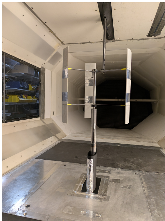
Figur 6.1: Slutgiltig modell monterad i vindtunnel
