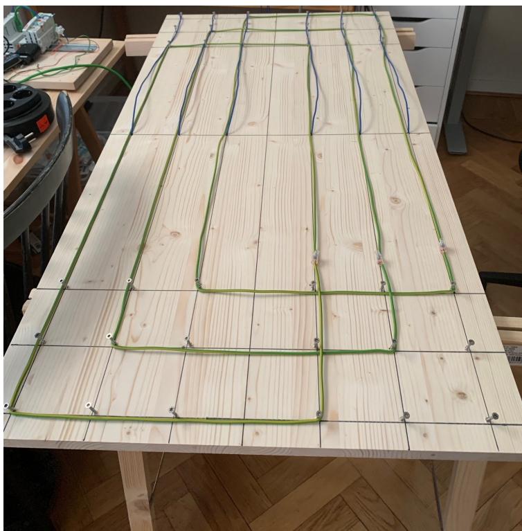
Figur 3.4: Miniaturmodellen med sina tre slingor. Blåa kablar föreställer inkommande respektive utgående kablar
