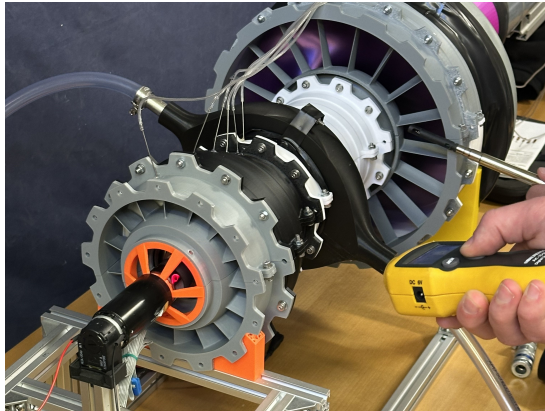
Figur 5.14: Mätning av varvtal. I bakgrunden syns hastighetsmätning av bypass-flödet.
