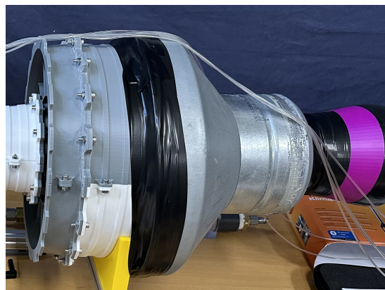
Figur 5.8: Främre kåpan ansluten till rör för massflödesmätning.
