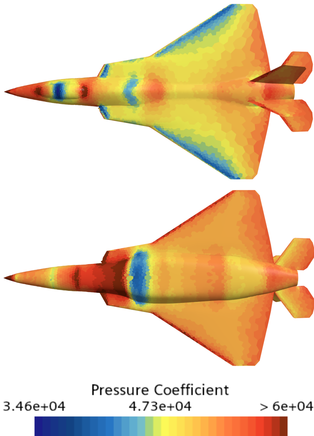
Figur 6.10: Tryckfördelning över flygplanets ovansida och undersida erhållen från simuleringar i StarCCM+ och gäller för marschflygning.
