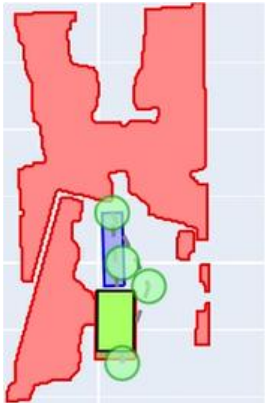
Figur 8: Bild på blå rutan som identifierar hinder framför roboten. Skärmbild från GPSS
