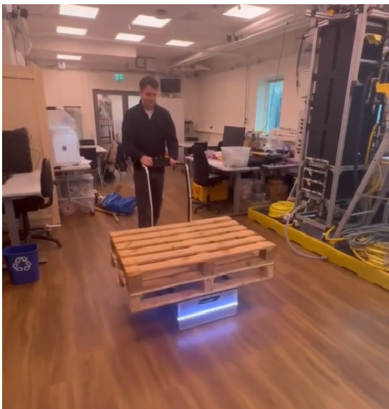
(a) Roboten lastas med två pallar och körs med styrspakar på handtaget
