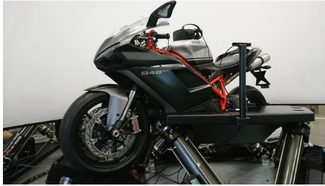
Figur 2 - Cruden B306 HMD, en avancerad simulator som kan röra sig i sex frihetsgrader, syns här med en Ducati 848 monterad på rörelseplattformen.
