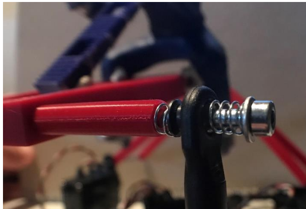
Figur 15 – Prototypens lösning på koncept 3 med skruv och fjäder.
