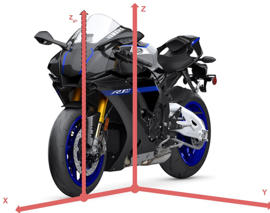
Figur 4 – Ett infört koordinatsystem på en Yamaha R1M för att ge ökad förståelse i vilken rörelse som benämns.
