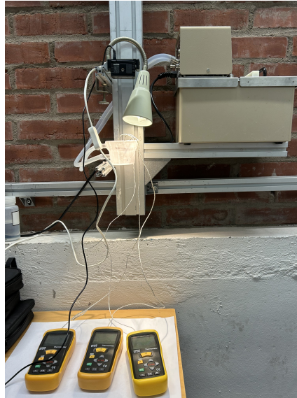
Figur 3.5: Uppställningen som användes för att studera muskelfantomens termokroma egenskaper. I figuren ses hållaren för muskelfantomen med de tre proberna kopplade till varsin termometer. Maskinen uppe till höger värmer och pumpar vattnet genom hållarens väggar.
