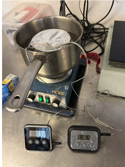
Figur 3.2: Uppställningen som användes för att testa effekterna av en längre och mer homogen omrörning och uppvärmning.
