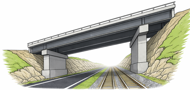
Figur 2.2: Exempel på balkbro. (Skapad med OpenAI).
